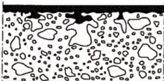
Rappresentazione schematica di un tipico rivestimento
