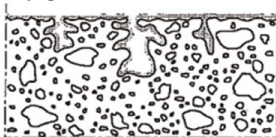
Rappresentazione schematica di una tipica impregnazione idrofobica
