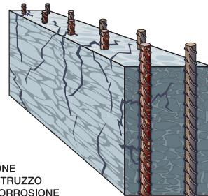
FESSURAZIONE DEL CALCESTRUZZO DOVUTA A CORROSIONE DELLE STRUTTURE METALLICHE
