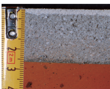
SEZIONE CON EVIDENZA DELLE STRATIFICAZIONI DI: MATTONE MACROPORE® RINZAFFO MACROPORE® INTONACO RASTUCCO RASATURA
